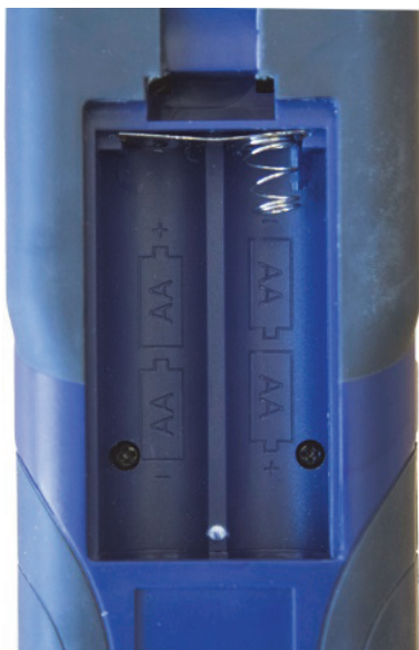
Fig. 19: Vano pile aperto
